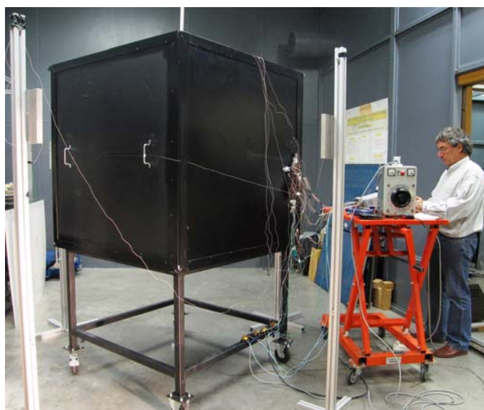
Photo 2 – Vue du cube extérieur dans la chambre climatisée.
