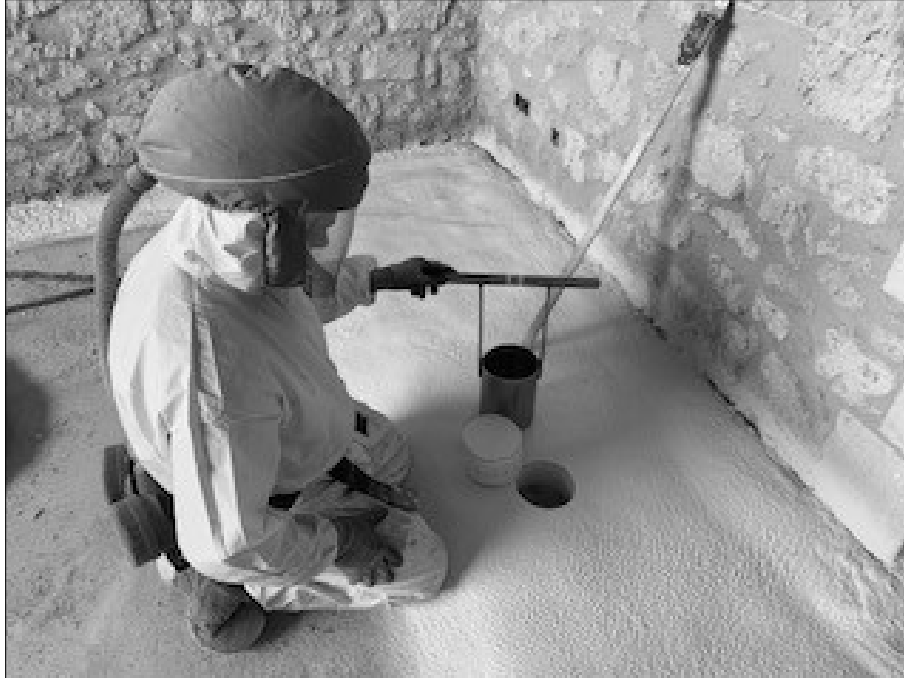
Figure 1 : Prélèvement des éprouvettes par carottage
