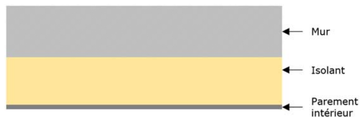
Figure 11 : Projection sans lame d'air (Cette configuration n'est pas applicable lorsque l'on recherche une performance acoustique)
