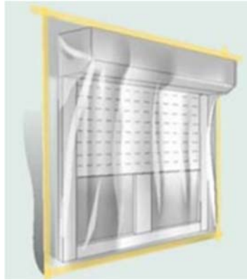
Figure 2 : Protection des éléments de construction
