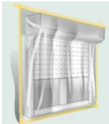
Figure 2 : Protection des éléments de construction
