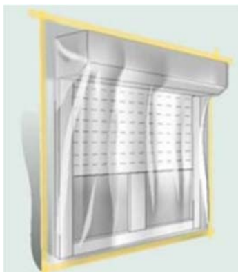
Figure 2 : Protection des éléments de construction
