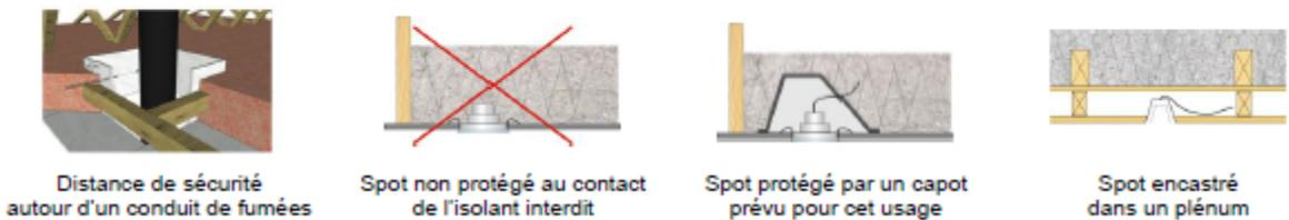
Ne pas mettre en contact l'isolant avec les dispositifs d'éclairage encastrés dans le plafond ou toute autre source de chaleur localisée afin d'éviter les échauffements excessifs
