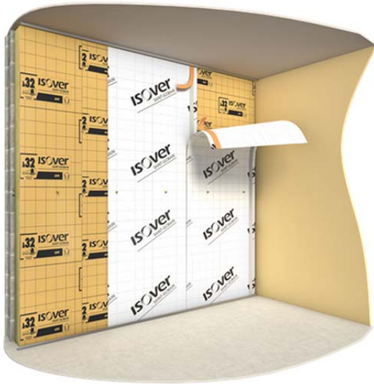
Figure 20 - Pose des membranes pré-adhésivées Vario® KM Duplex UV Fast et Vario® Xtra Fast : (a) pose des membranes préadhésivées en mur ; (b) le collage de ces membranes doit se faire adhésif sur adhésif, certains bords non pré-adhésivés nécessiteront l'utilisation d'un adhésif Vario® KB1 ou Vario® Multitape ou Vario® Fast Tape avec un recouvrement de 10 cm.
