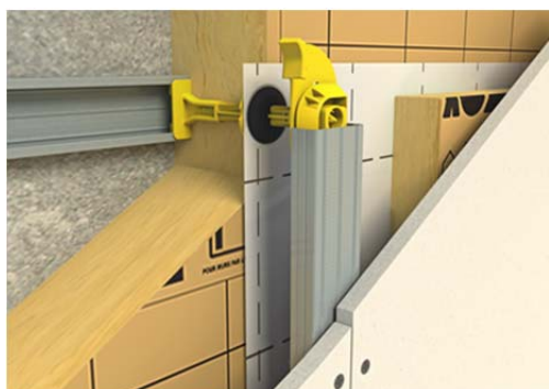
Figure 26 – Variante de mise en œuvre de la membrane entre deux couches d'isolant en mur maçonné avec la pastille Optima 2
