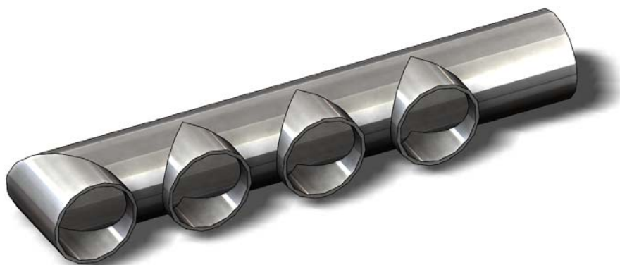
Figure 5 – Schéma d'un regard d'accès centré
