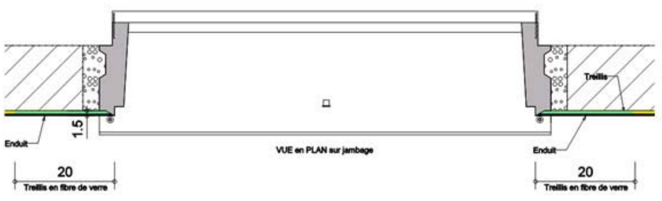
Figure 8 - Positionnement du treillis de renfort pendant l'enduit "TRADITION"
