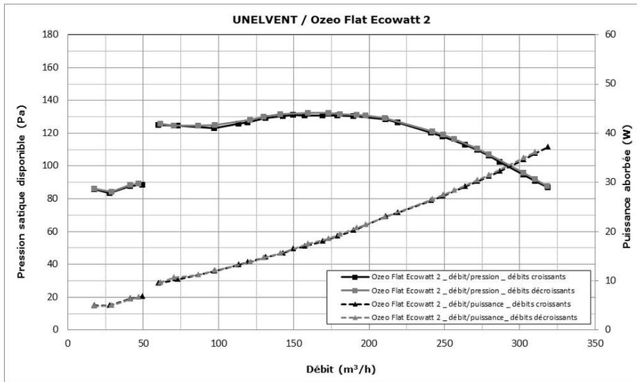
Figure 7 - Groupe d'extraction « Ozeo Flat Ecowatt 2 » - courbes caractéristiques
