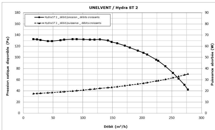
Figure 4 - Groupe d'extraction « Hydra ST 2 » - courbes caractéristiques
