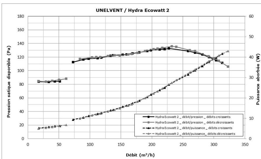
Figure 5 - Groupe d'extraction « Hydra Ecowatt 2 » - courbes caractéristiques
