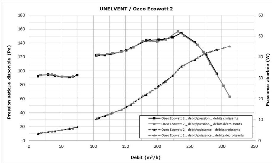
Figure 8 - Groupe d'extraction « Ozeo Ecowatt 2 » - courbes caractéristiques
