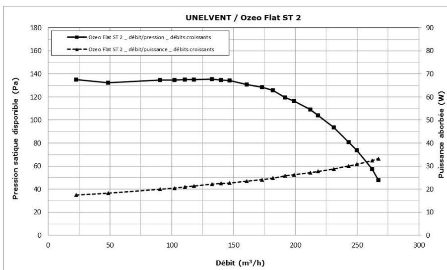
Figure 6 - Groupe d'extraction « Ozeo Flat ST 2 » - courbes caractéristiques
