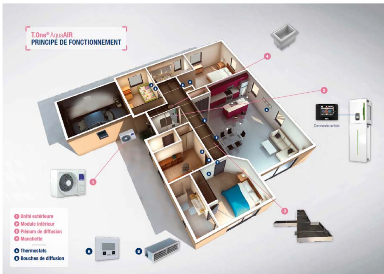
Figure 2 – Schéma de principe du système "T.One® AquaAIR"
