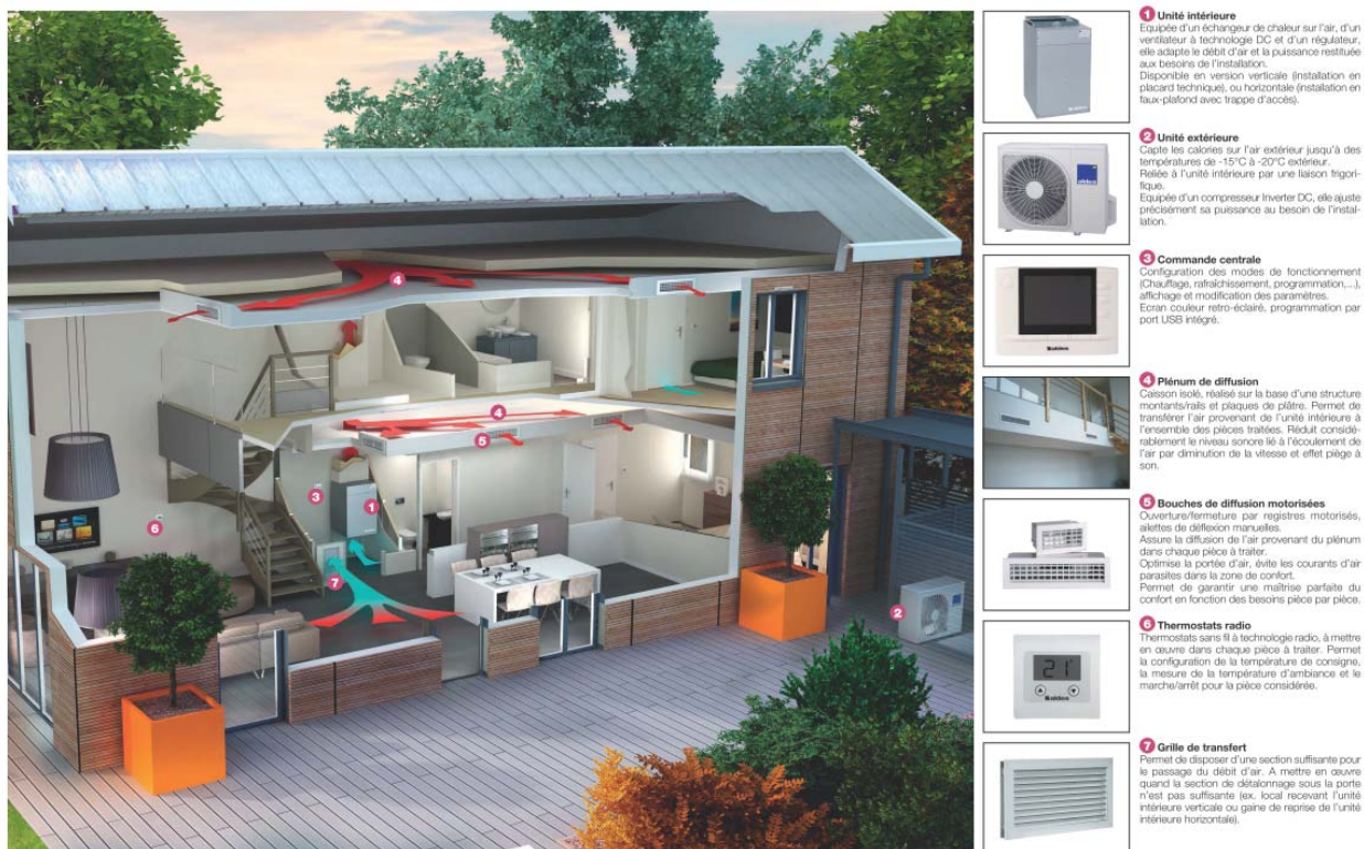
Figure 1 – Schéma de principe du système "T.One" (avec unité intérieure verticale)
