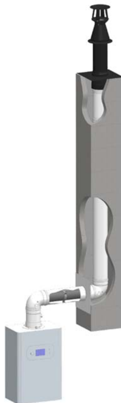
Figure 8 – Schéma de principe en configuration pour un montage dans un conduit existant Configuration C 6 (C 3 ) pour appareil à gaz avec conduits concentriques (PPH CONCENTRIC) et terminal 1A
