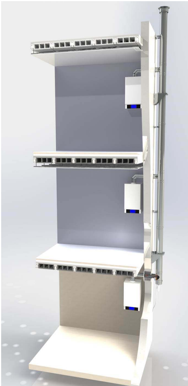
Figure 3 – Principe de la version 3CEP TRIO ext (à l'extérieur du bâtiment)
