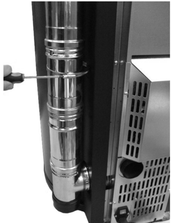
Figure 3 – Exemple de configuration avec sortie arrière à 90° (modèle SFERA3)
