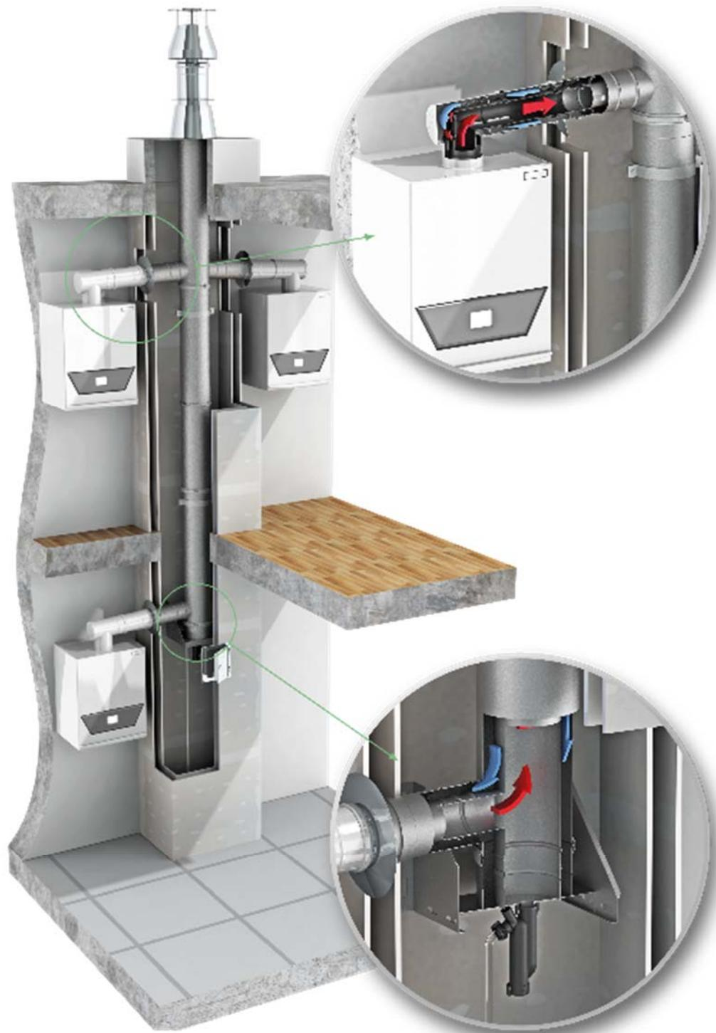
Figure 1 - Principe de la version TWIN 3CEP à l'intérieur (parties privatives) d'un bâtiment
