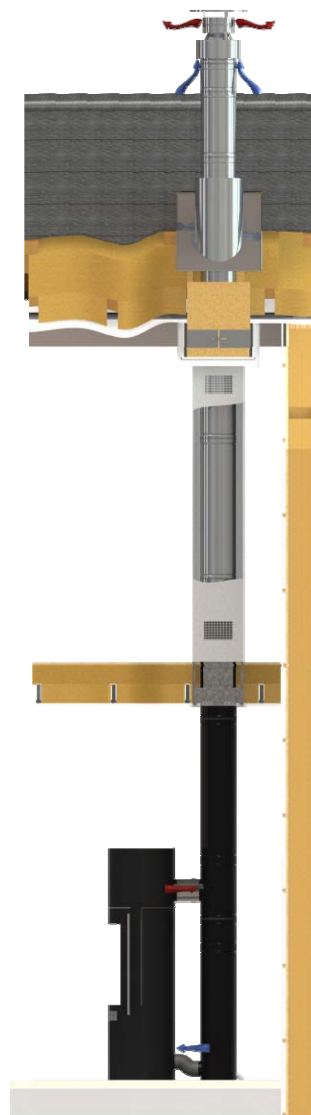
Figure 2 : Configuration concentrique verticale (conduit concentrique isolé MFI)
