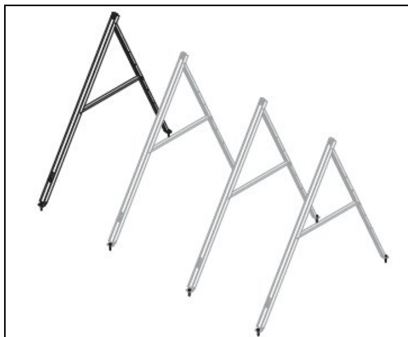
Figure 19 – Mise en œuvre des châssis par vissage direct dans la structure du bâtiment (plots béton).
