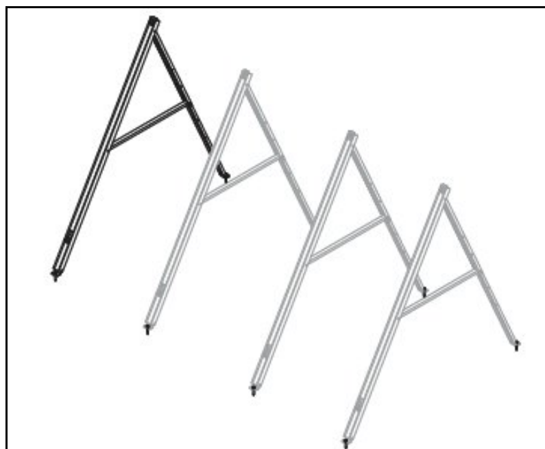
Figure 16.3 – Mise en œuvre des châssis par vissage direct dans la structure du bâtiment (plots béton).
