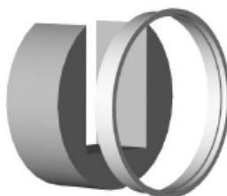
Figure 20c – Mousse acoustique et pièce de maintien pour Bouche d'extraction hygroréglable et/ou temporisée SdB
