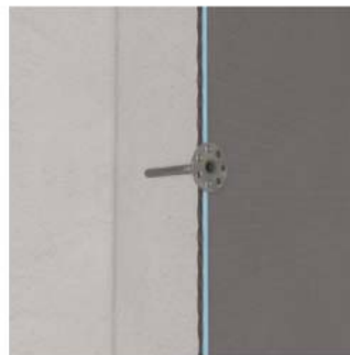
4 – Détail de fixation : cheville à frapper
