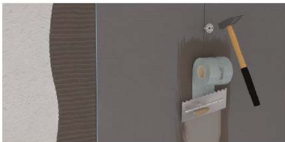
3 – Collage et chevillage (option bande étanche ou mastic wedi 610 entre panneaux)
