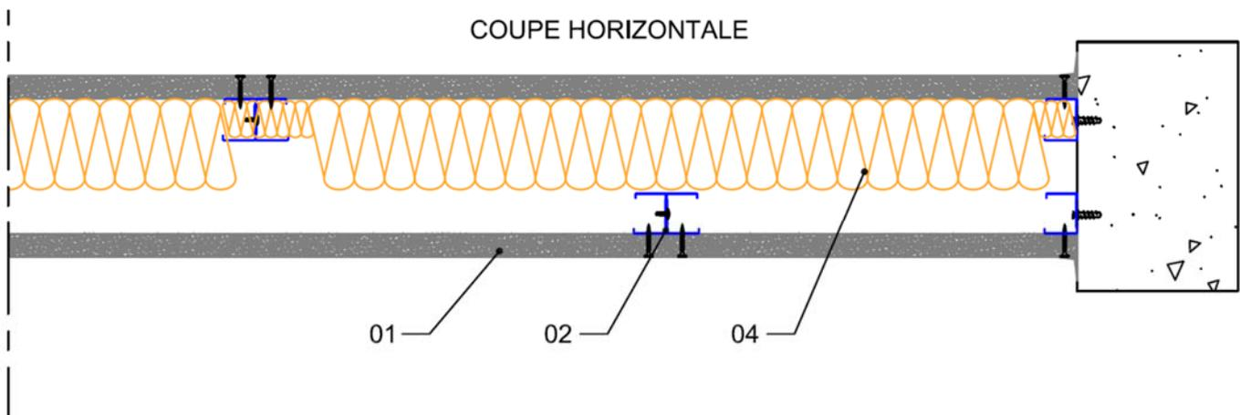
Figure 1 – Coupes de principe – Cloison PREGYMETAL S/900
