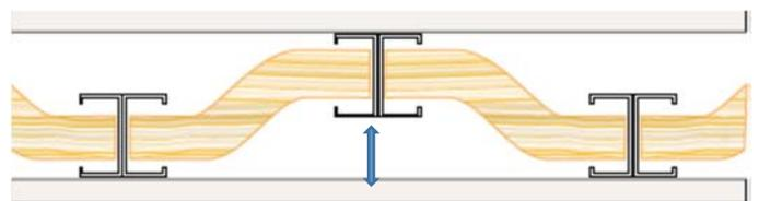
Figure 7 - Jeu minimum entre montants et dos de plaque opposée
