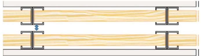
Figure 6 - Jeu minimum entre montants en vis-à-vis
