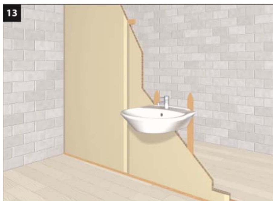
Figure 13 - principe de renfort bois de largeur \geq 80 mm
