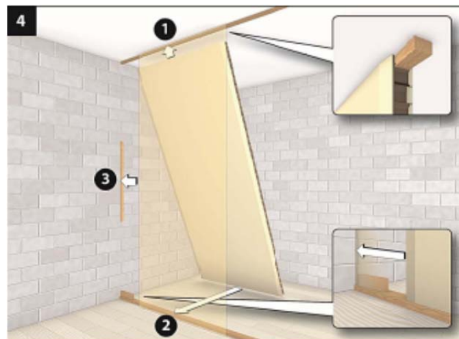
Figure 4 – Mise en œuvre du premier panneau (2/2)
