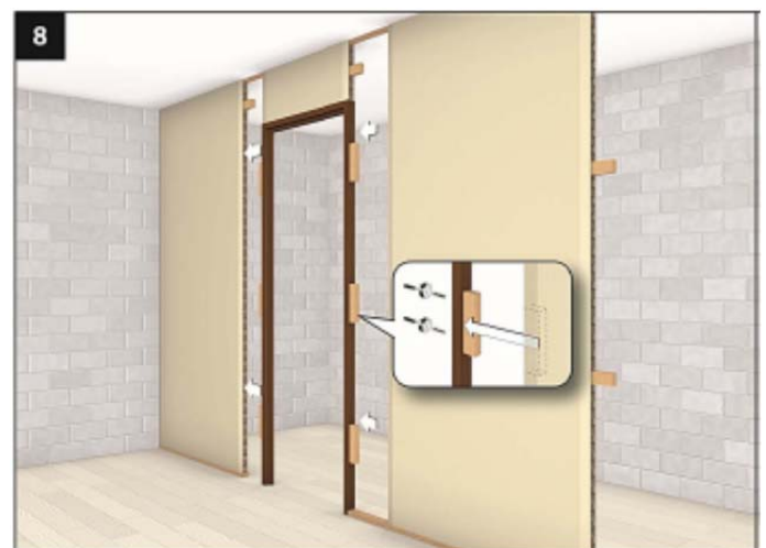
Figure 8 – Mise en œuvre de d'une huisserie
