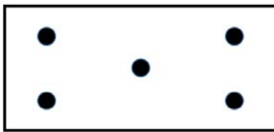
Figure 1c : Système avec panneaux isolants STEICOprotect L dry de dimensions 1200 × 400 mm
