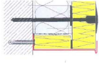
Figure 2c : Ancien profilé disqué Nouveau profilé standard
