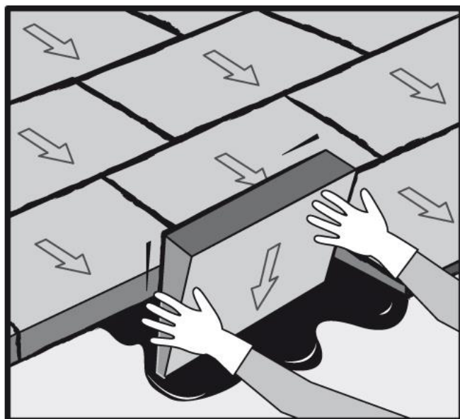
Figure 1b – Pose de la plaque isolante Les deux bords de la plaque sont trempés dans le bitume
