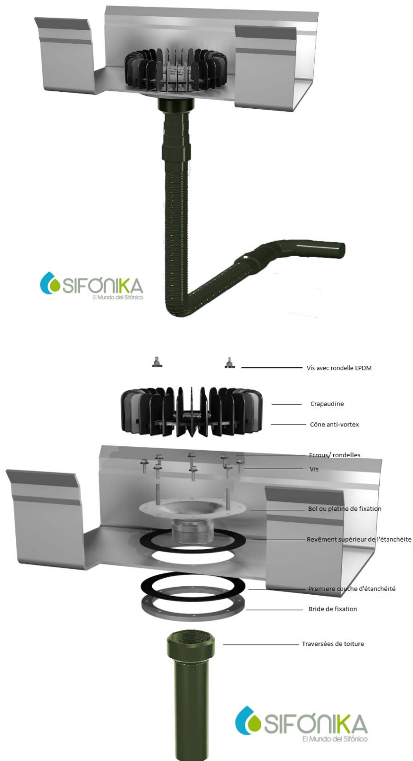
Figure H – Coupe de principe avec chéneau extérieur
