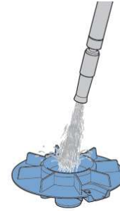
L'accessoire trop-plein est nettoyé puis la propreté est vérifiée.
