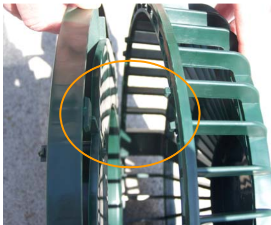
Figures 7.2 – La soucoupe et la grille sont clipsées ensemble
