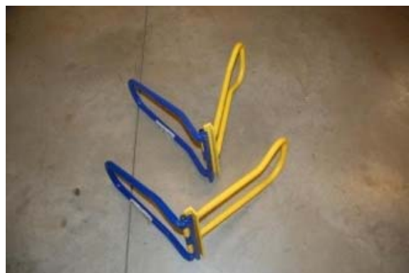
Figure 8 – Exemples de sertisseuse électrique (ex : Draco K9) et de pinces manuelles à joint debout
