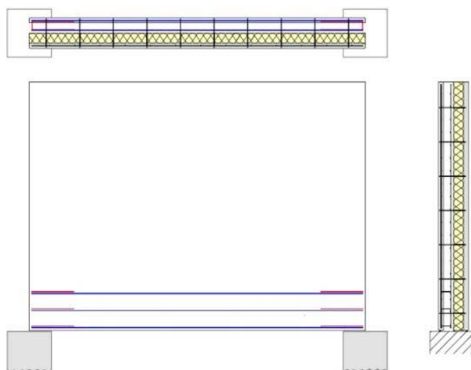
Figure 59 – Poutre voile d'un seul tenant
