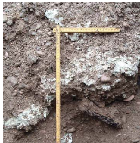
Photo 1 - Conglomérat résine-graviers + sables
