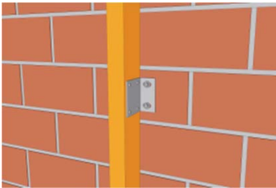
Montage de l'ossature primaire
