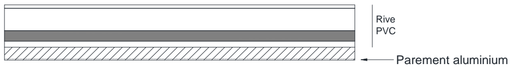
1. Coupe horizontale > Pose horizontale Panneau avant façonnage
