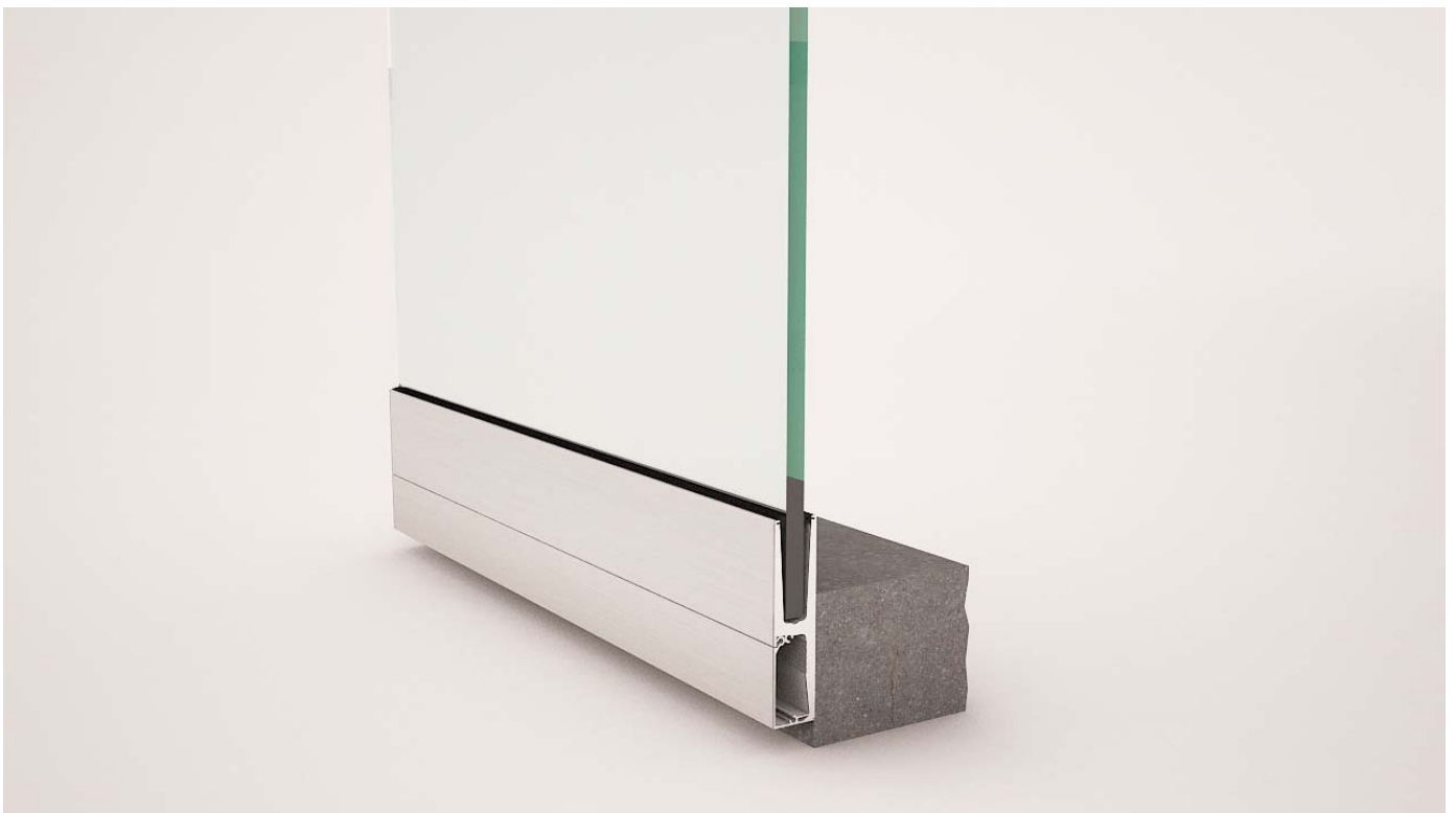
Figure 2 – Schéma 3D du système en nez de dalle.
