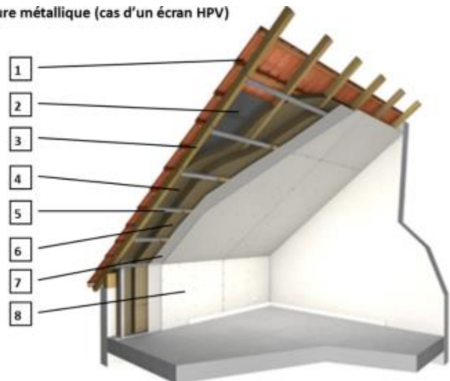
Figure 4-2-1 – Mise en œuvre du pare-vapeur et du parement intérieur sans vide technique
