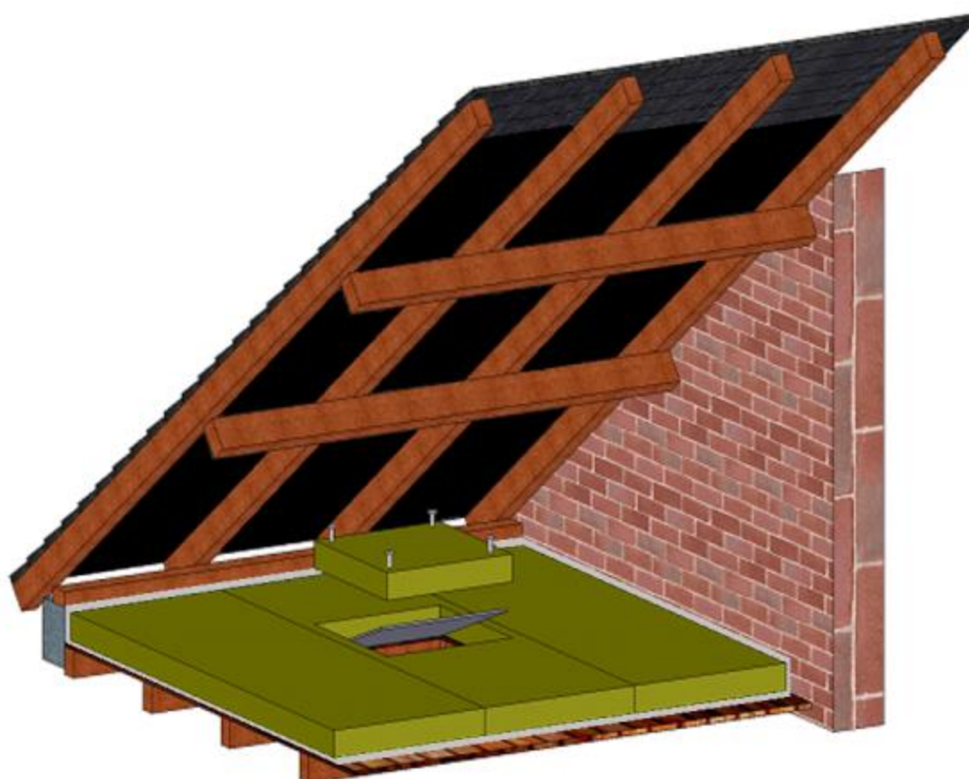
Figure 7 – Mise en œuvre en plancher de comble perdu
