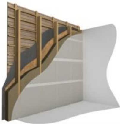
Figure 6-3 : Pose de la membrane pare-vapeur, contre les panneaux Gramitherm, sur l'ossature bois
