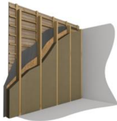
Figure 6-2 : Pose des panneaux Gramitherm entre les montants de l'ossature bois et en contact avec les panneaux de contreventement HPV
