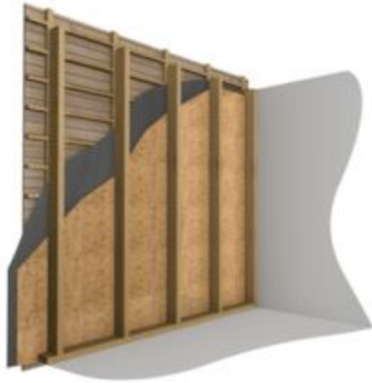
Figure 6-1 : Mur à ossature bois avec panneaux de contreventement HPV + membrane pare-pluie HPV et bardage ventilé
