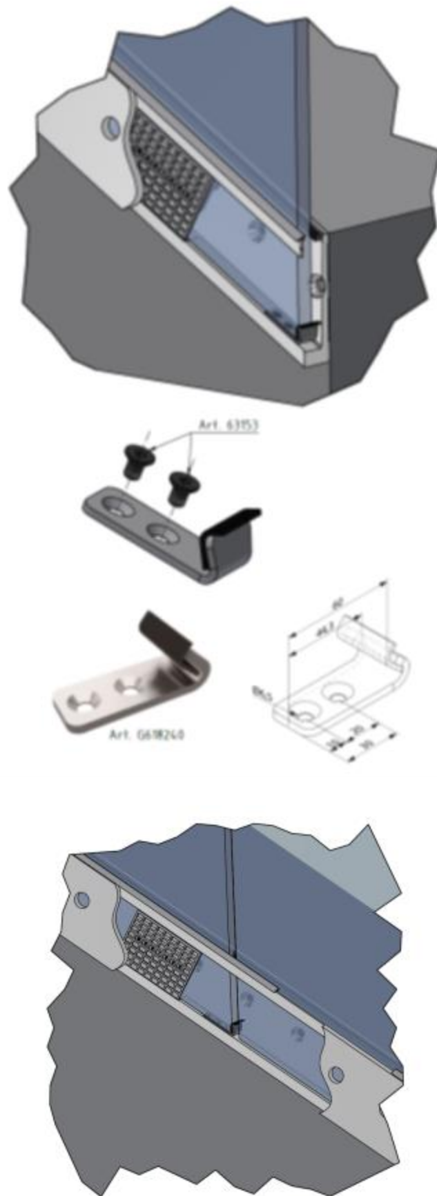
Figure 17 – Cas des garde-corps rampants – Pièce de blocage
