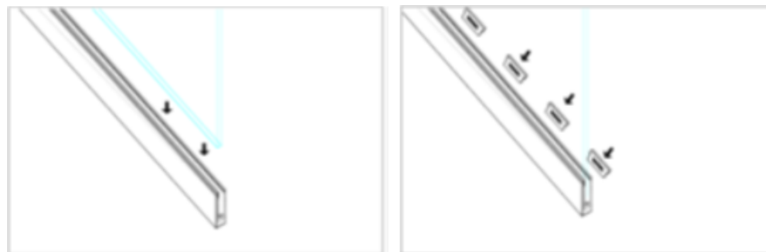
Figure 16.c - Installation du verre
