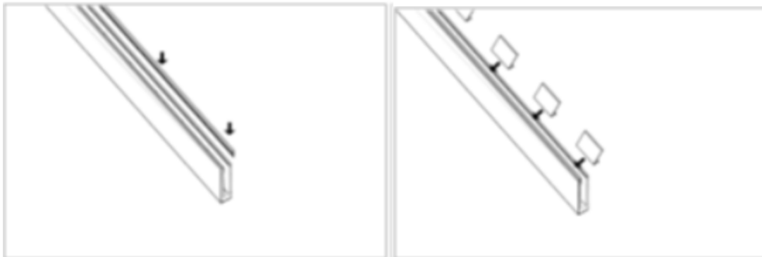
Figure 16.a – Perçage dans la structure et montage des profilés
