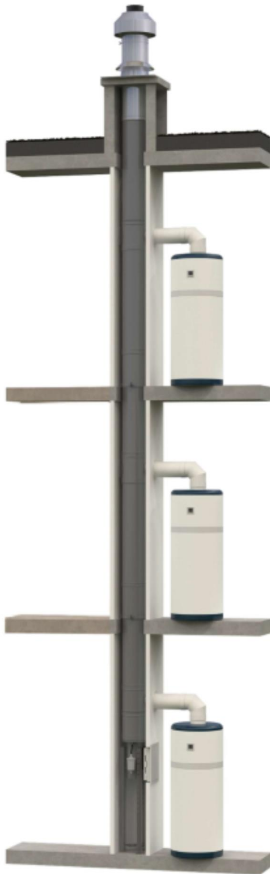
Figure 7 – Montage du système en situation intérieure
