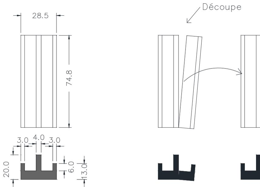
**Figure 7 - Jonction entre lisses horizontales**
