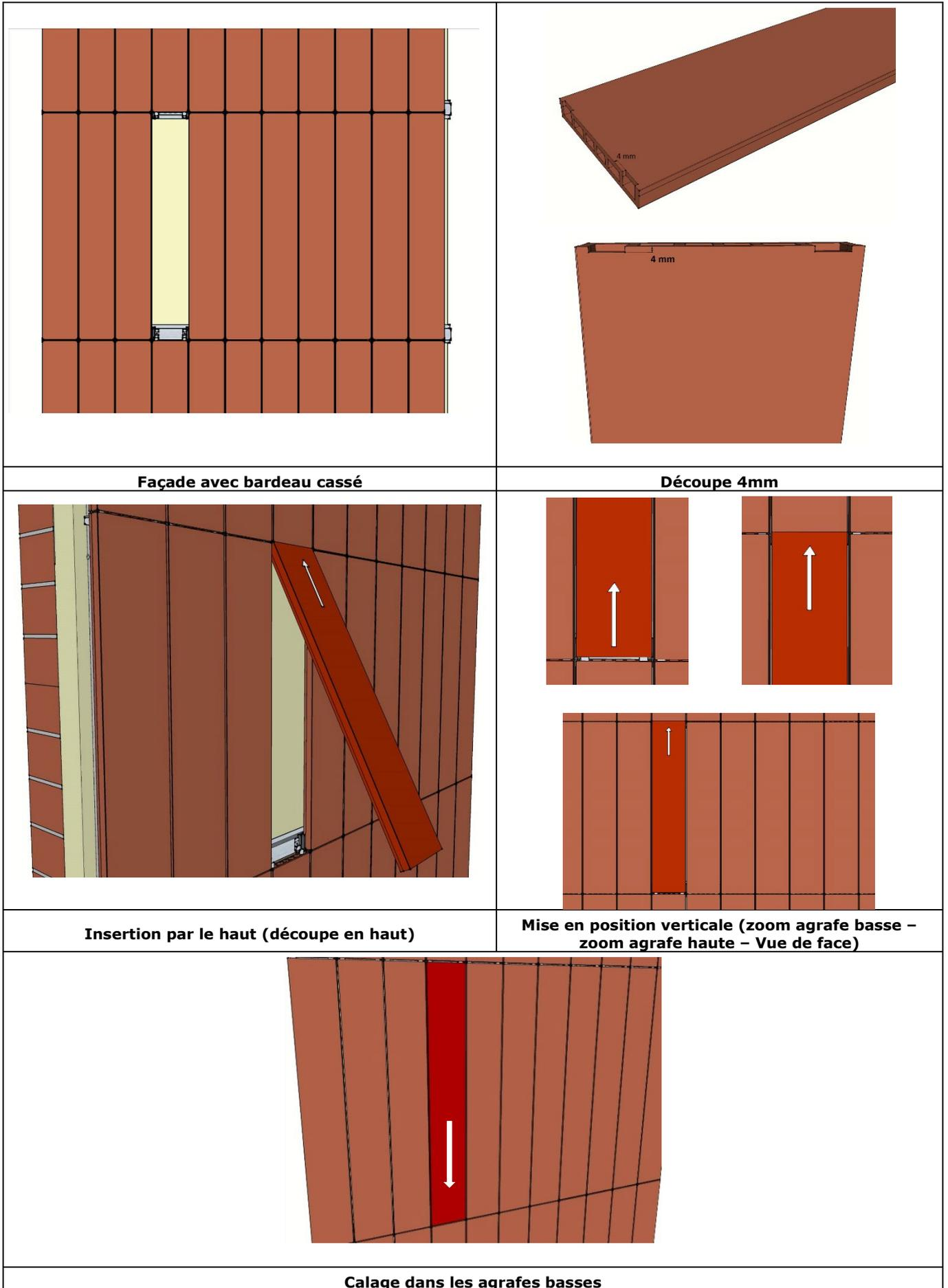
**Figure 21 – Principe de pose renforcée (représentation de pose sur support béton)**
