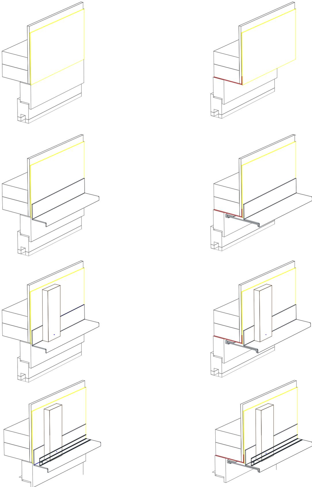
**Figure 20 – Remplacement d'un bardeau**
