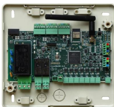
Figure 4b – Contrôleur central - AZPV8CB1IAQ
