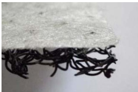
Figure 2 - Coupe sur l'Enkadrain® B10-1s
