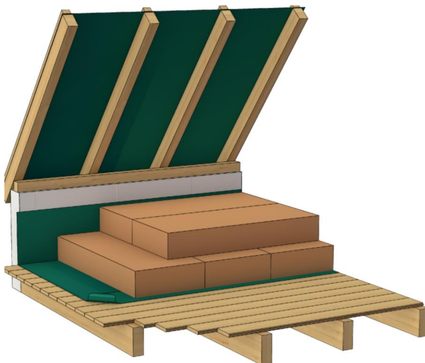
Figure 6 – Isolation sur plancher de combles perdus
