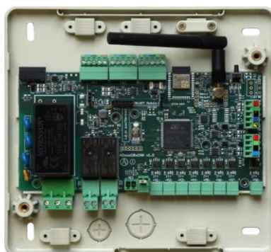
Figure 4b – Contrôleur central - AZPV8CB1IAQ
