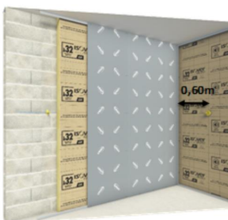
3. Mise en œuvre des plaques Habito®, des raccords Optimax, et de la cornière verticale Stil® CR2 au niveau de l'angle
