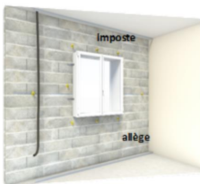
1. Implantation des cornières Stil® CR2/rails hauts et bas, et celle des embases et tiges des appuis Optimax
