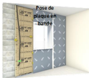
6. Installation à l'avancement des plaques Habito® (pose en drapeaux non autorisée), et des raccords Optimax. Réalisation des bandes et passe d'enduit.
