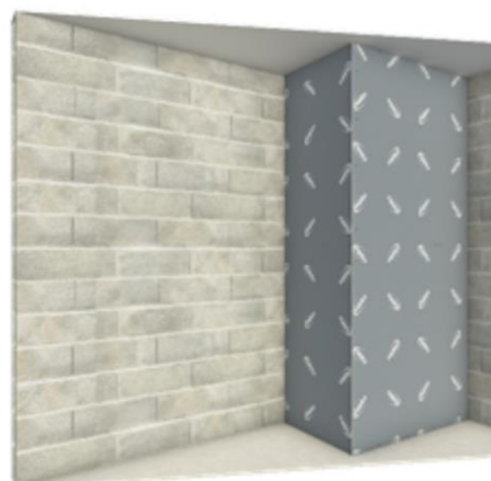
4. Vissage de la deuxième plaque sur la cornière verticale, les cornières/rails hauts et bas, et les appuis et raccords Optimax
