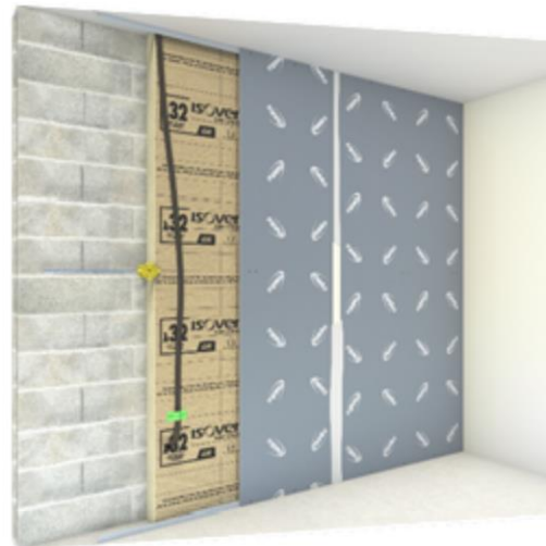
4. Mise en place de la plaque adjacente, réalisation des bandes et passe de l'enduit
