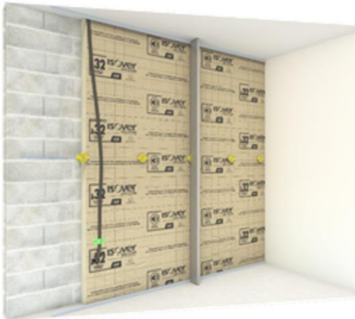
1. Mise en place des platines des appuis Optimax et contrôle de la planéité
