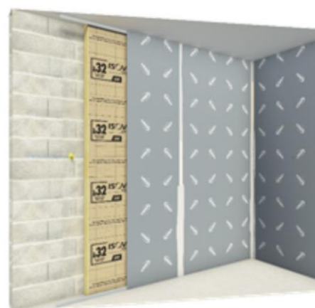
4. Mise en œuvre de la plaque du deuxième mur et réalisation des bandes et passe d'enduit
