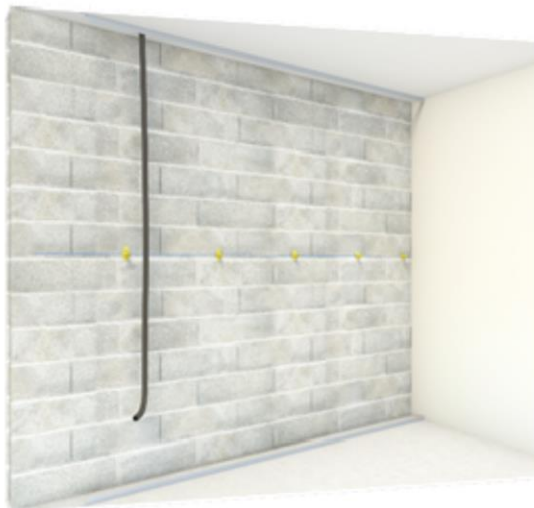
3. Implantation des embases et tiges des appuis Optimax
