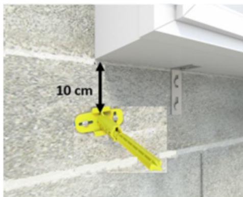
2. Zoom sur l'implantation des appuis depuis le dormant du menuiserie (à 10cm) (exemple : embase verticale)
