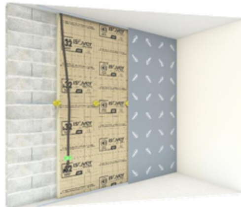
2. Installation de la plaque Habito®
