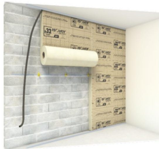
4. Mise en œuvre de l'isolant (exemple : sous forme de rouleaux)
