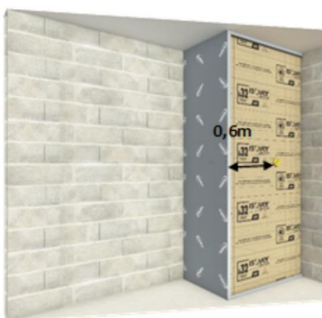
3. Installation de la plaque et de la cornière verticale au dos de la plaque
