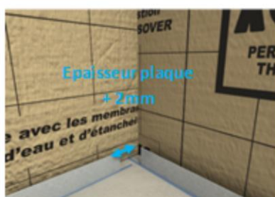
3. Mise en œuvre des plaques Habito®, des raccords Optimax, et de la cornière verticale Stil® CR2 au niveau de l'angle
