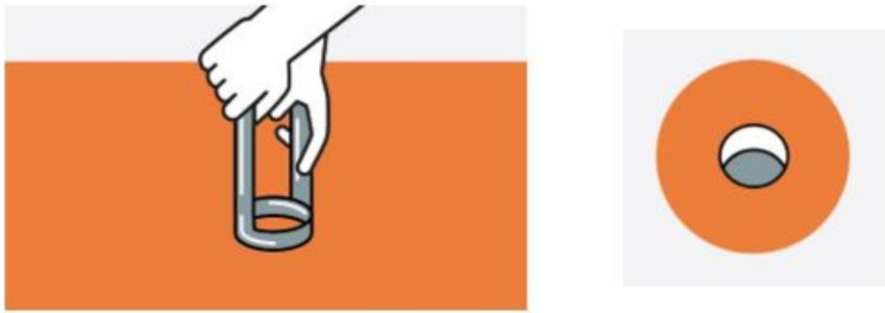
Figure 3 : Prélèvement des éprouvettes par carottage
