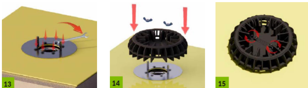
Etapes d'installation d'une naissance Sifonika-membrane
