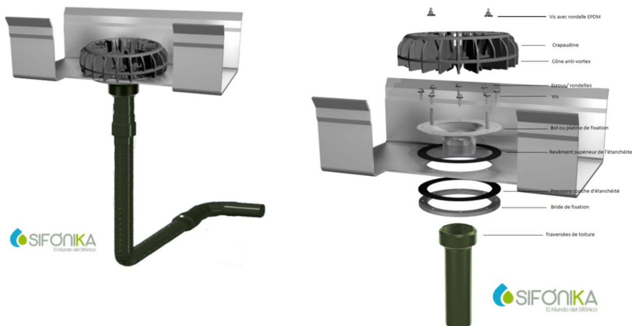
Figure 9 - naissance Sifonika-gouttière
