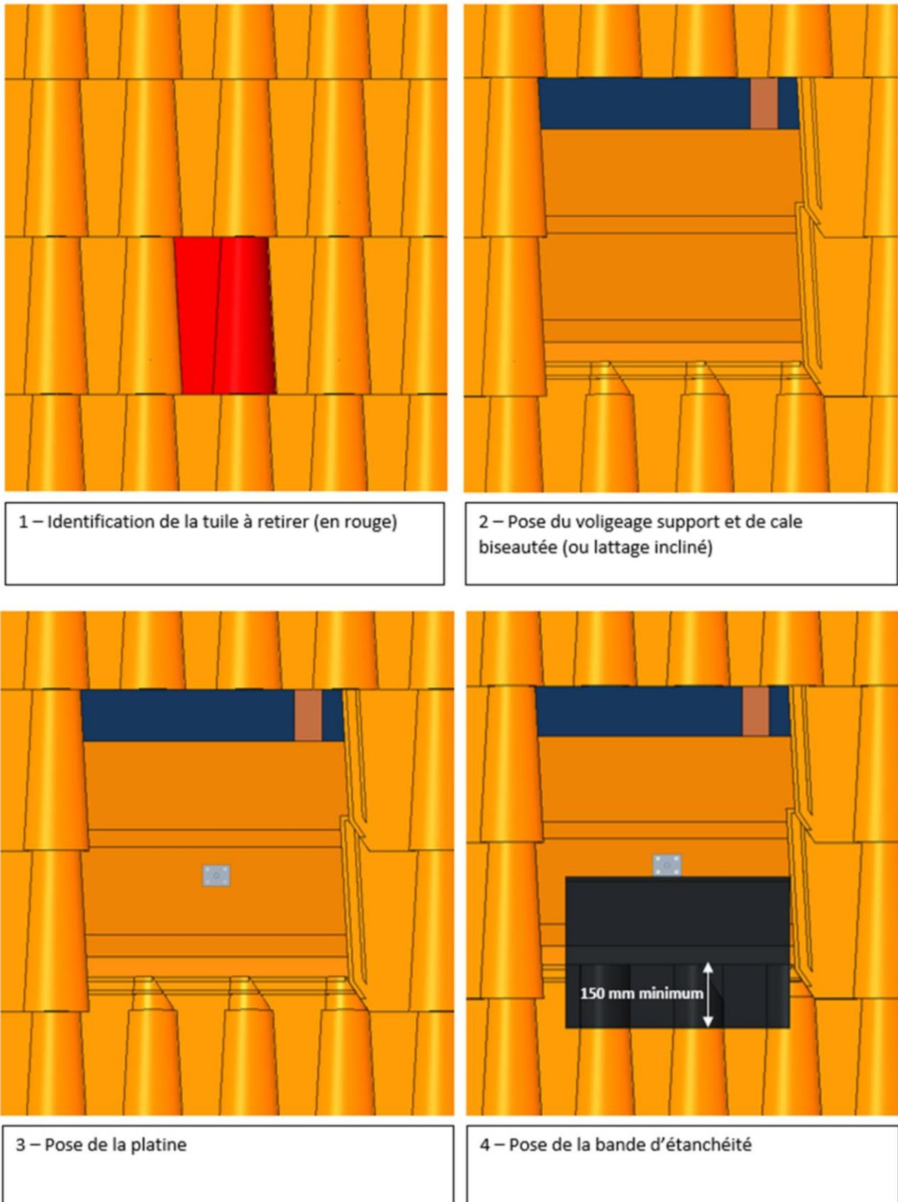
**Figure 14 : Pose des ensembles de fixation à la charpente (tuiles terre cuite)
