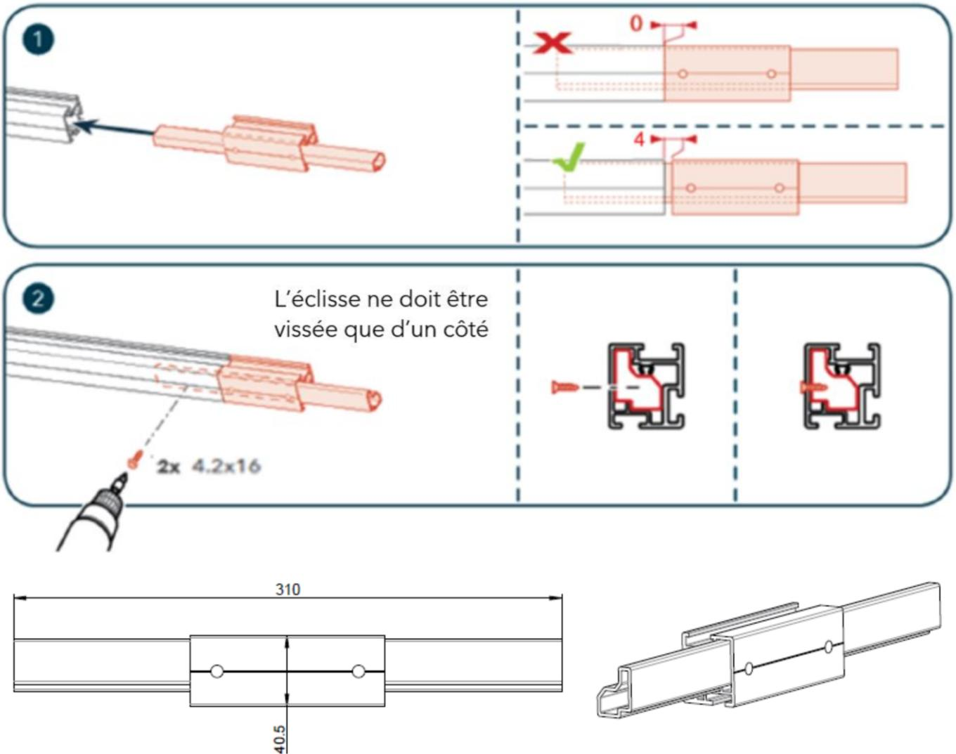
**Figure 7 : Raccordement des rails par éclisses**
