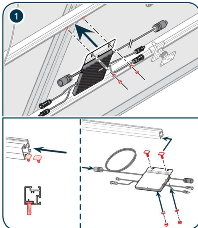
**Figure 12 : Exemple de fixation d'un micro-onduleur**
