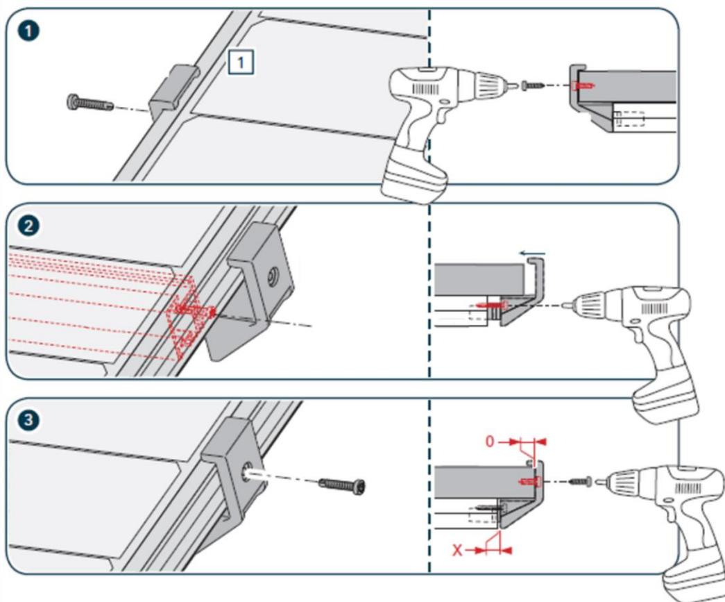
**Il est nécessaire d'utiliser un embout long pour le vissage**
