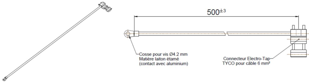
**Figure 10 : Câble de liaison équipotentielle des masses**
