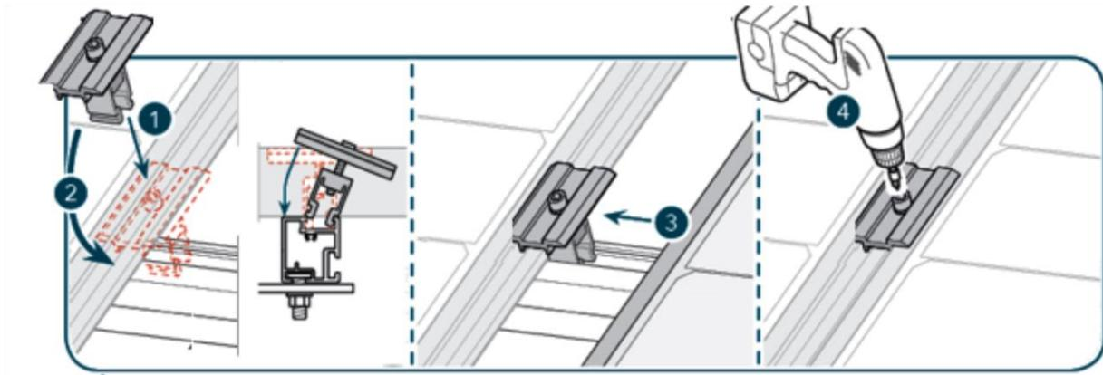
**Figure 18 : Mise en place des brides intermodules**
