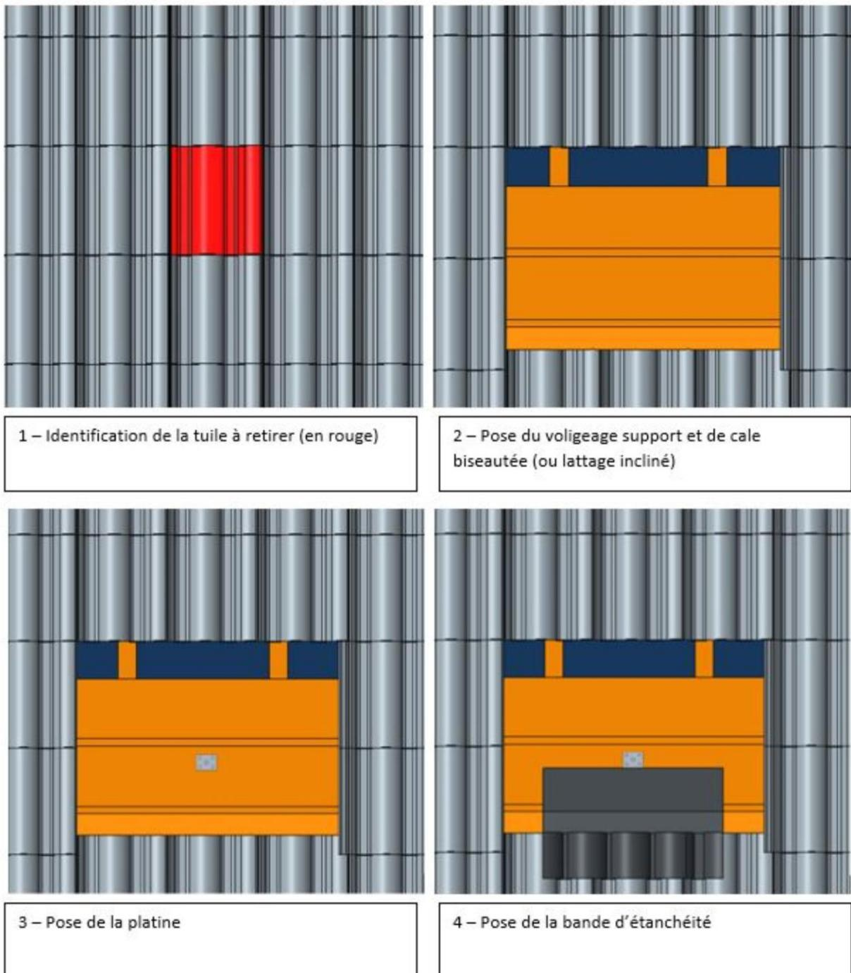
**Figure 14 : Pose des ensembles de fixation à la charpente (tuile béton)
