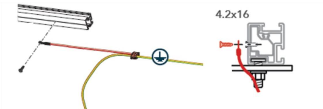
**Figure 11 : Câble de liaison équipotentielle des rails**
