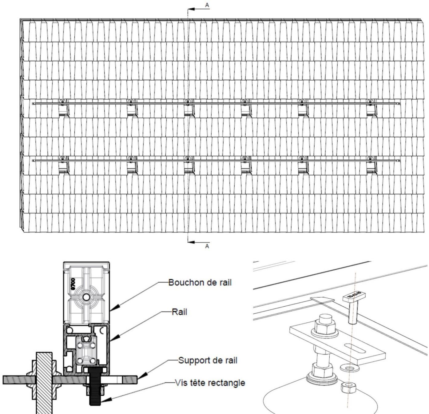
**Figure 16 : Pose des rails**
