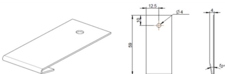
**Figure 3 : Patte de maintien de la tôle emboutie**
