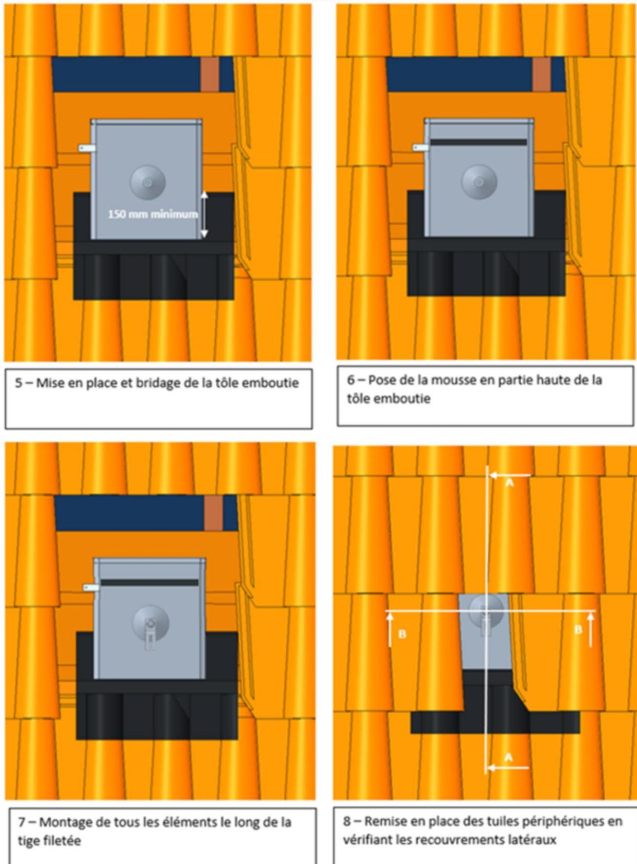
**Figure 14 : Pose des ensembles de fixation à la charpente (tuiles terre cuite) (2/5)**
