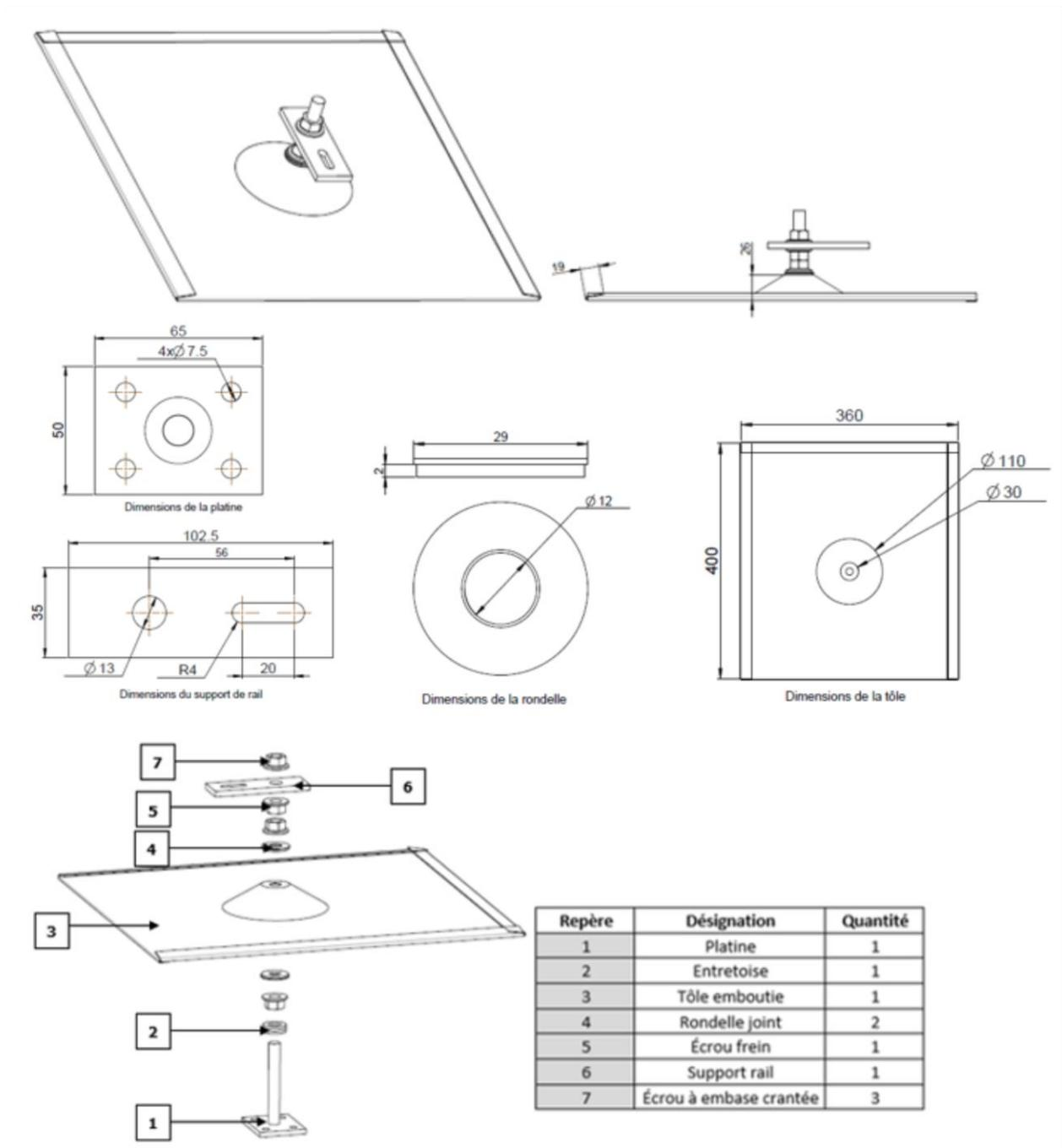
**Figure 2 : Ensemble de fixation à la charpente**
