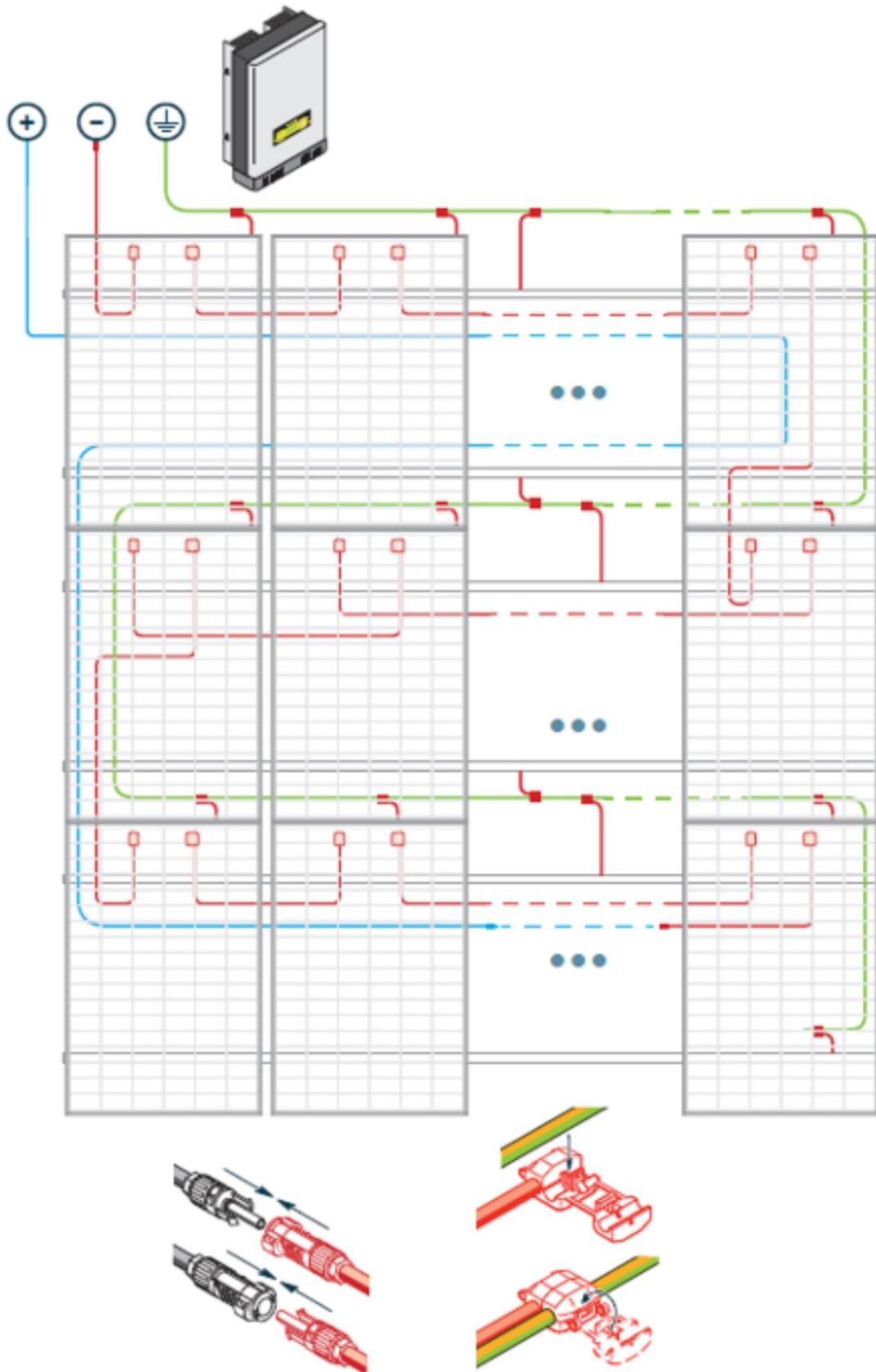
**Figure 8 : Principe de câblage avec onduleur centralisé**
