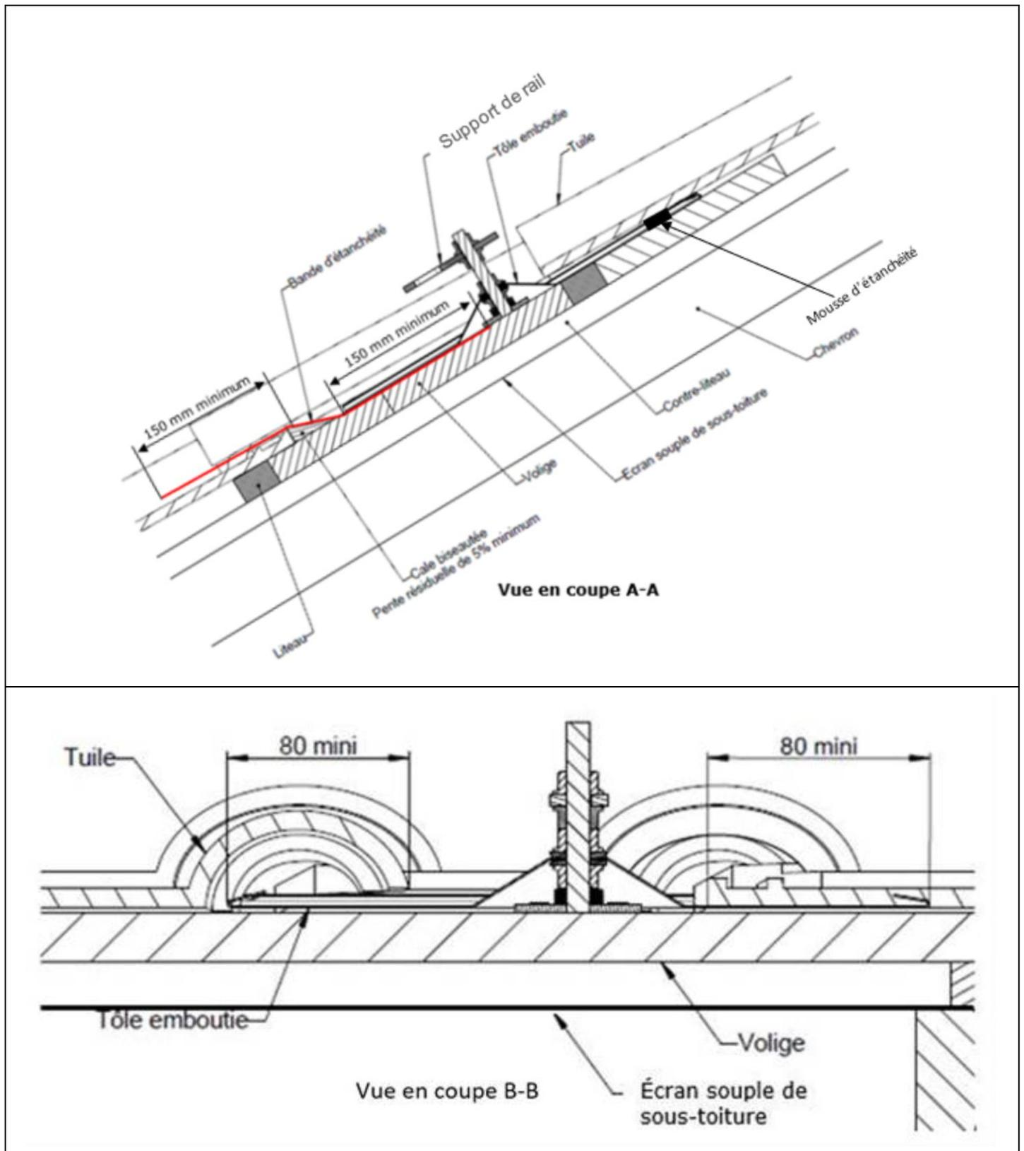
**Figure 14 : Pose des ensembles de fixation à la charpente (5/5)**
