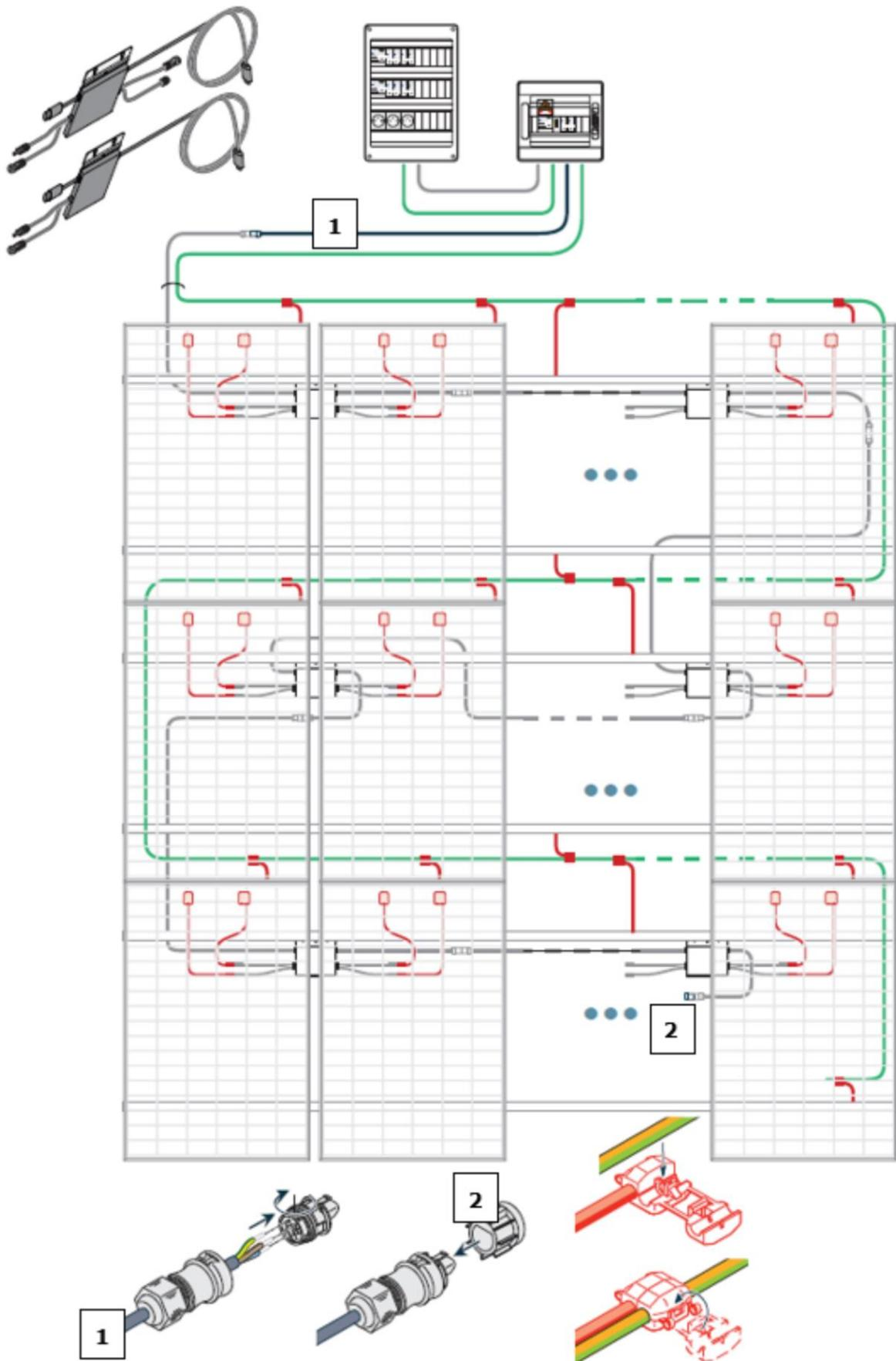
**Figure 9 : Principe de câblage avec micro-onduleur**
