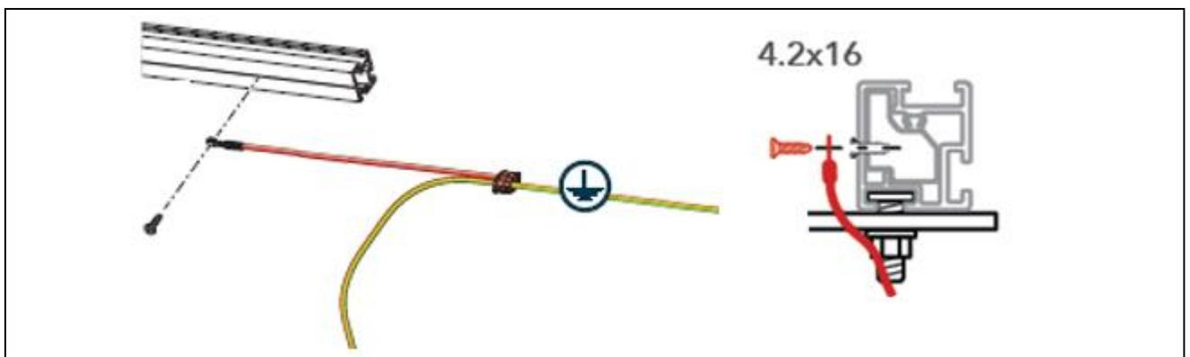
**Figure 11 : Exemple de fixation d'un micro-onduleur**
