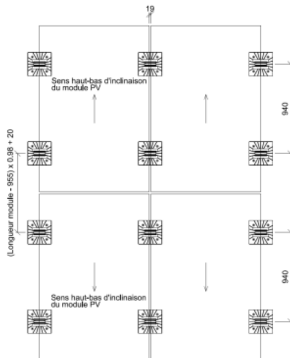
Figure 32 : Implantation des plots SOPRASOLAR FIX EVO avec modules photovoltaïques en inclinaison double shed - réhausse polymère
