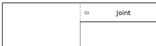
Fractionnement au droit de l'angle saillant
